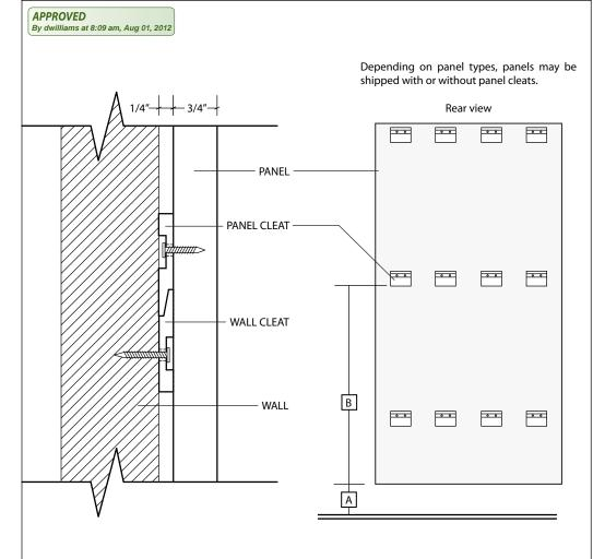
INSTALL WALL CLEAT BETWEEEN MULTIPLE PANELS AS SHOWN (OVERLAPPING). WALL CLEATS MAY NEED TO BE TRIMMED ON SITE ON OUTER SIDES AS NEEDED.
